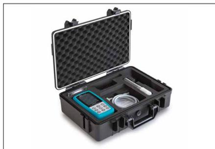
Materiale in dotazione: Blocco di durezza standard (ca. 61 HRC), cavo USB, unità display, unità sensore UCI, valigetta per il trasporto, software per il trasferimento dei dati salvati al PC, altri accessori
